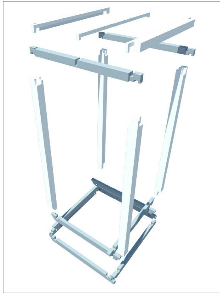
Esploso scheletro strutturale modulo 2x2x3.5 m
