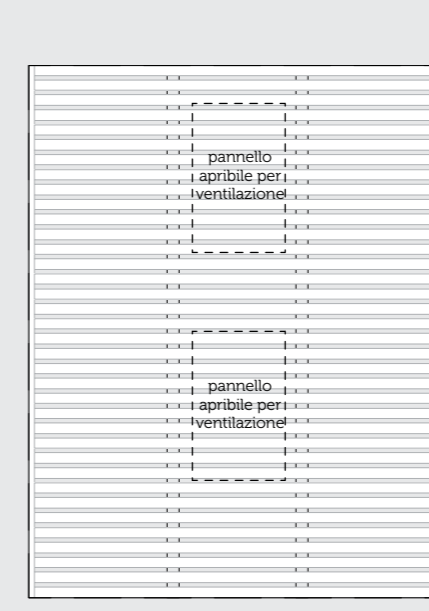
Pianta copertura in listelli di legno. Eventuale ancoraggio di un tessuto impermeabile all'interno come protezione dalle intemperie
